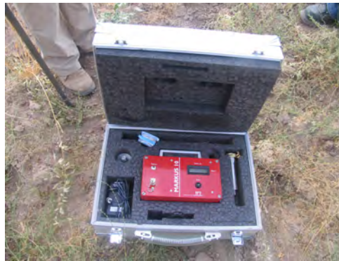
Şekil 1.2. Markus 10 Radon ölçer cihazından görünüm.
