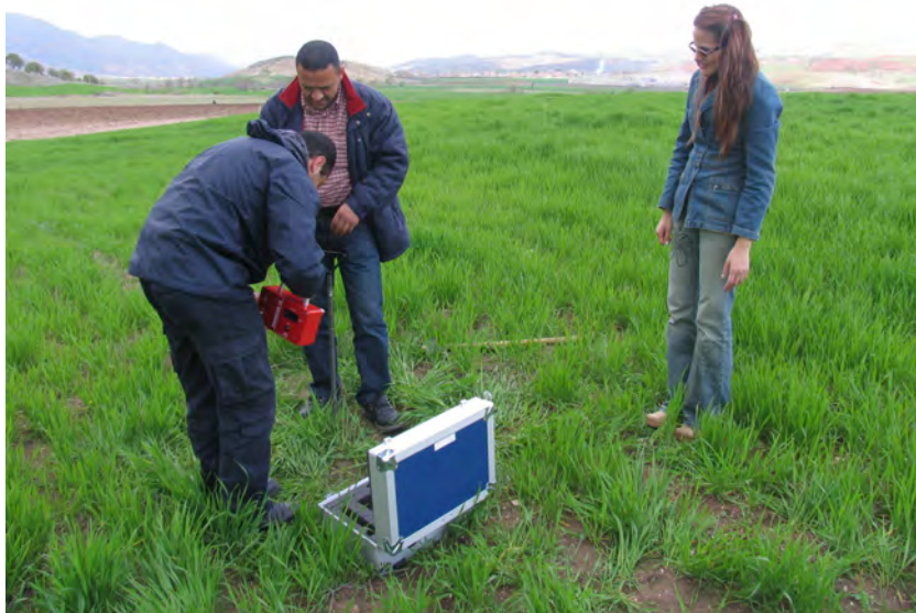
Şekil 5.9. Markus 10 Radon ölçer cihazı ile Seğintepe'nin güneyinde yapılan ölçüm çalışmaları
